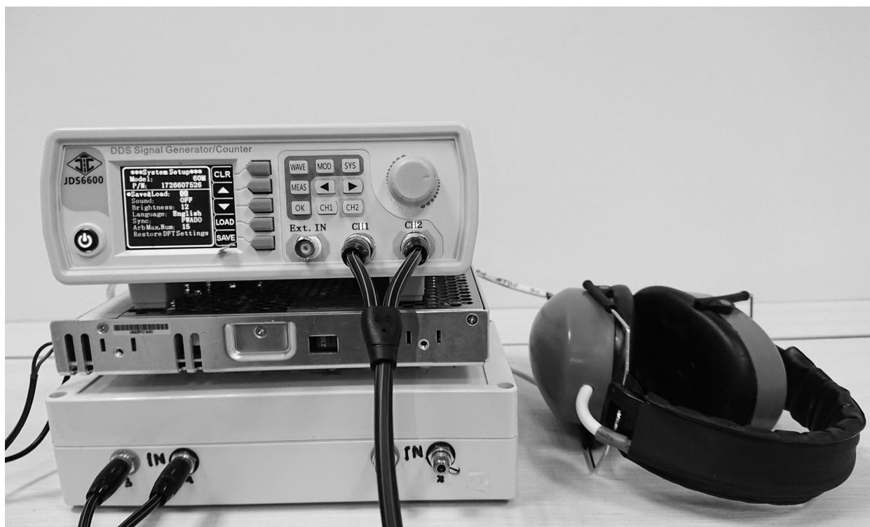
Рис. 2. Фото экспериментальной установки для электромагнитной стимуляции слуха.
