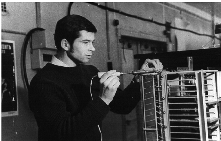
Рис. 9. Наладка АЦП на ЭВМ «Днепр-21» (фото В. Н. Чихмана, 1971 г.)
