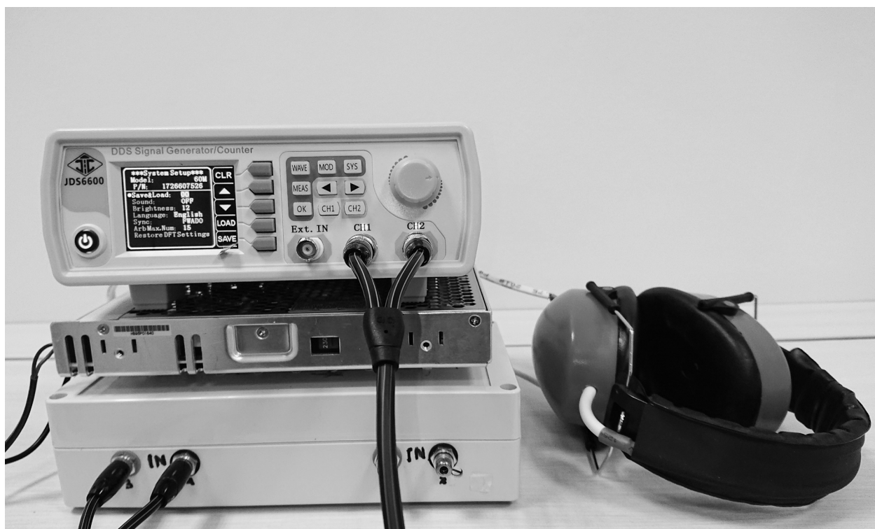
Рис. 2. Фото экспериментальной установки для электромагнитной стимуляции слуха. Фото Б. Ф. Щёголева, 2024
