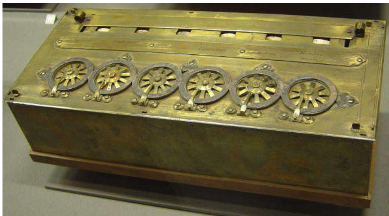
Рис. 3. Паскалина — суммирующая машина Паскаля
